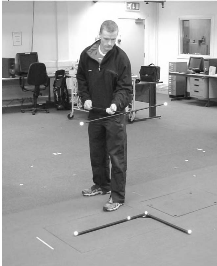
Fig. F2.4. Wand calibration
